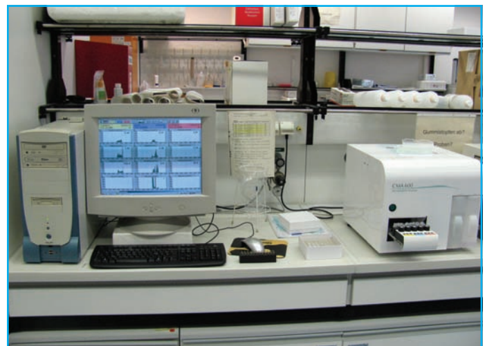
Abb. 3 Analytische Verfahren. (A) HPLC für die Bestimmung von Acetylcholin im femtomol-Bereich. (B) Mikroanalysator für die Messung von Metaboliten des Energiestoffwechsels.
