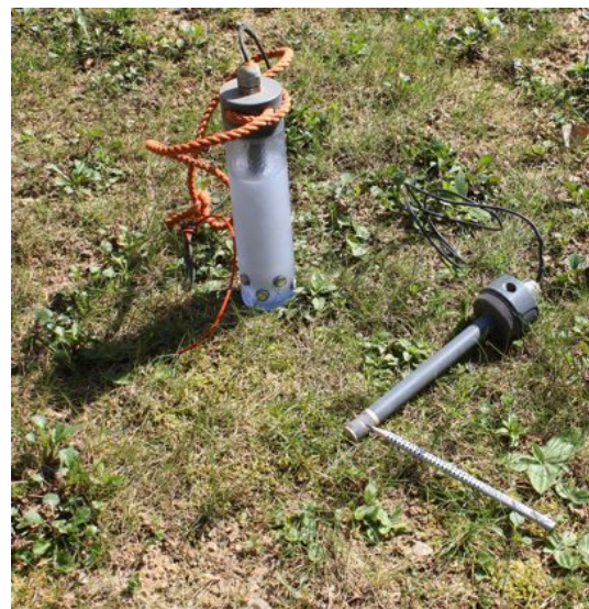
Abb. 3.8: AgAgCl/KCl-Elektrode links: Elektroden-PVC-Gehäuse mit Gelfüllung bereit zum Feldeinsatz rechts: Silberelektrode (an der Bleistiftspitze) samt PVC-Halterung
