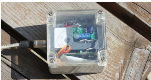
Abb. 3.6: GEOLORE DCF77 Funkuhr
