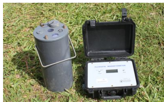
Abb. 3.9: GEOMAG drei Komponenten Fluxgate Magnetometer (links) mit Steuereinheit (rechts)
