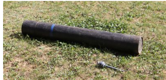
Abb. 3.7: MFS-05 Induktionsspule (METRONIX), die Elektrode dient dem Maßstab
