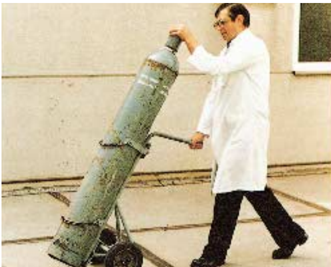
Bild 13: Druckgasflaschen müssen sowohl beim Transport auf den dafür vorgesehenen Wagen als auch am Standort durch Anketten gegen Umfallen gesichert werden.
